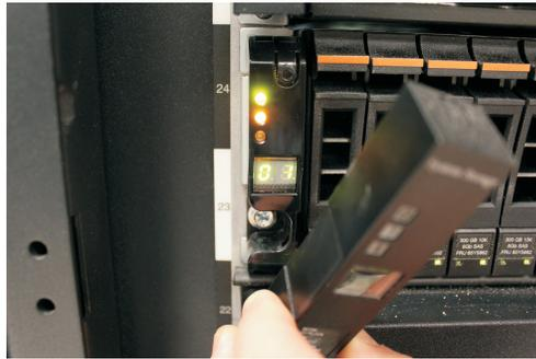
Figura 27. Removendo a Tampa da Extremidade do Gabinete
