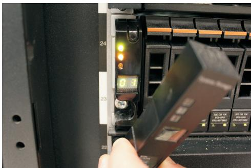
Figura 33. Removendo a Tampa da Extremidade do Gabinete
