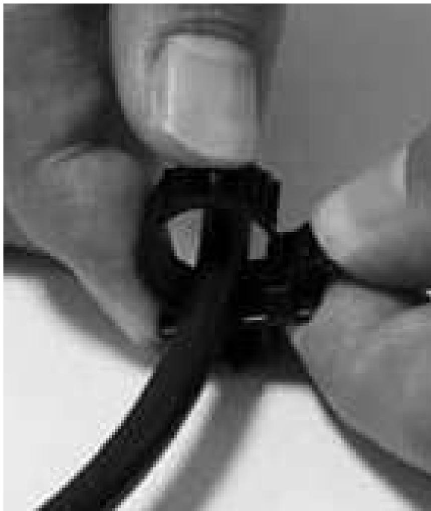
*Figura 57. Destravando o Suporte de Retenção de Cabos*
